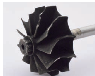
Uszkodzenie koła turbiny na skutek zmęczenia wysokocyklowego
